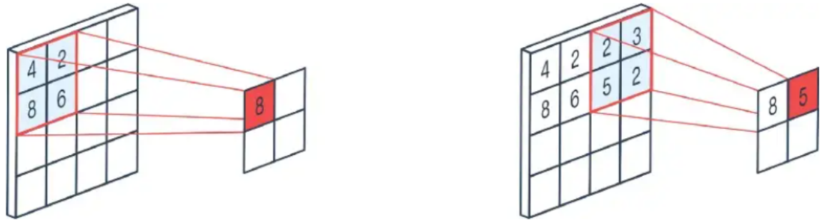
Fig. 1.2 Max pooling layer
