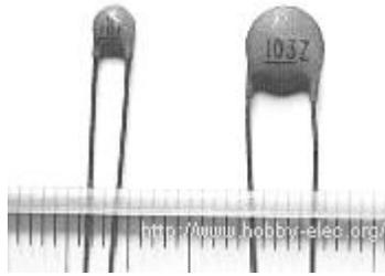
Fig 20. CERAMIC CAPACITORS
