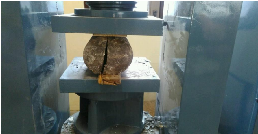
Fig.3.5(Split Tensile Failure)
