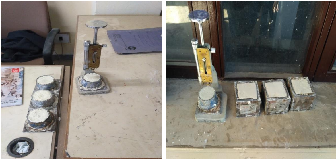
Fig 4.1 - IST and FST by Vicat Apparatus
