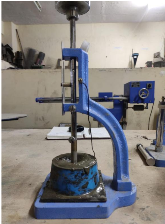
Figure 3.4 Apparatus for IST and FST.
