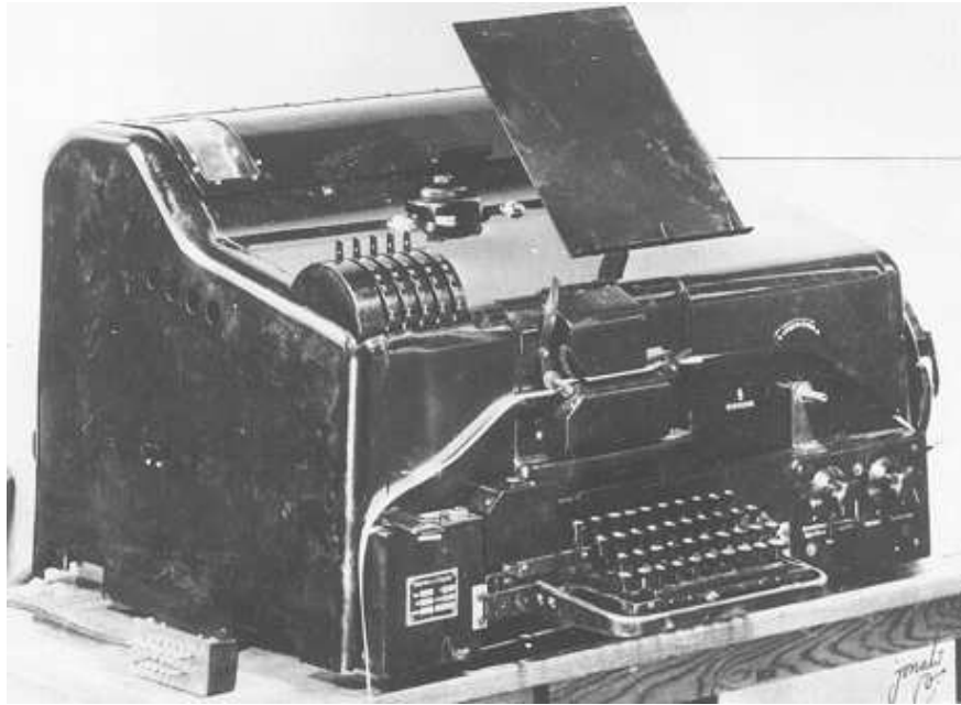
Figure2. “Geheimschreiber” or “G-skrivaren” ( Schlüsselfernschreibmaschine T52c ).
