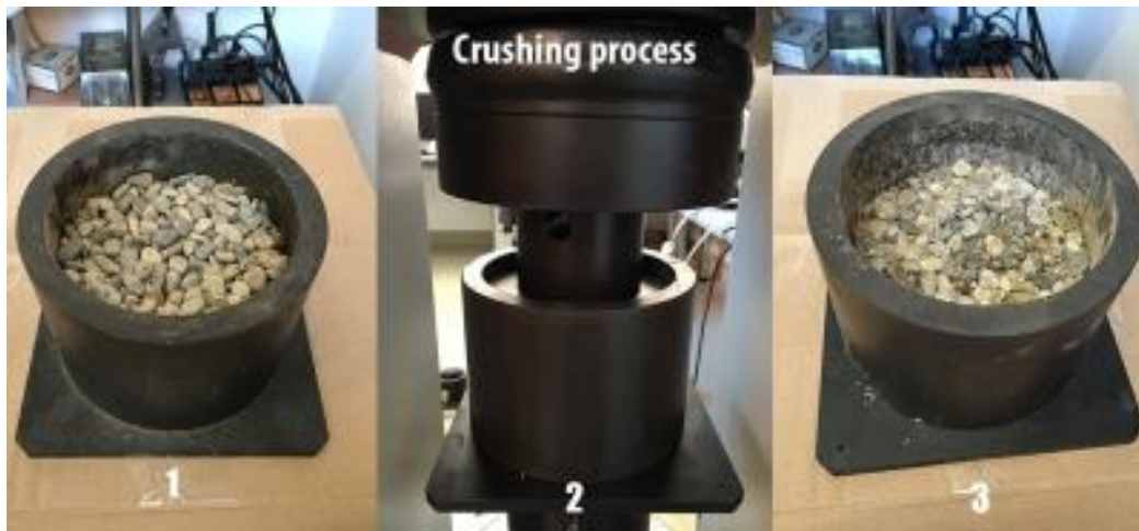
Fig. 9-Crushing Value Test Apparatus
