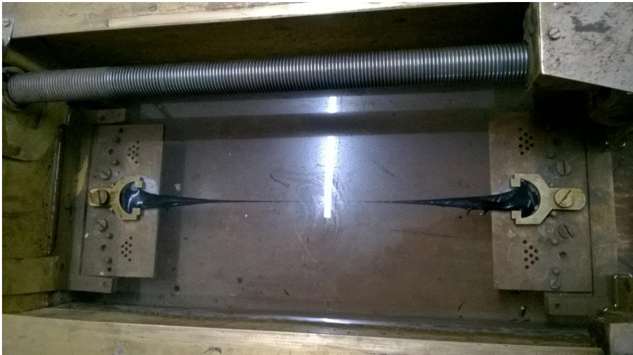
Fig. 12 -Ductility Value Test Apparatus
